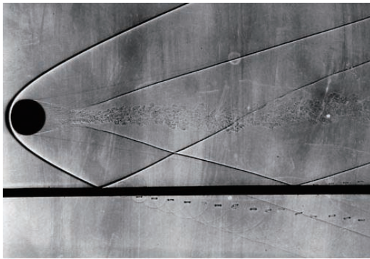
그림 6. 구의 초음속 이동에 의한 음장 가시화 (Schlieren법)
