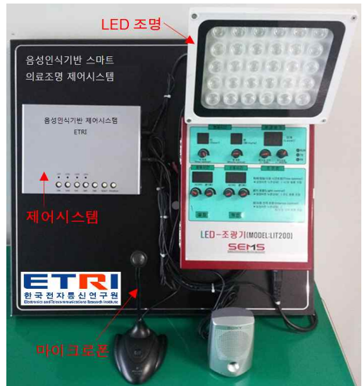
그림 4. 음성인식기반 의료조명제어시스템 시제품
