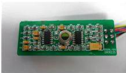
그림 13. 적외선감지모듈 Fig. 13 Infrared Sensing Module
