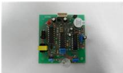
그림 12. 자외선감지모듈 Fig. 12 UV Sensing Module
