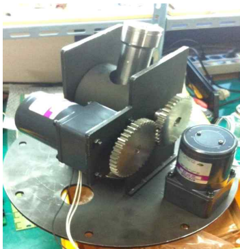
그림 11. 구현한 화재진압장치 Fig. 11 Implementation of Fire Extinguishing Apparatus
