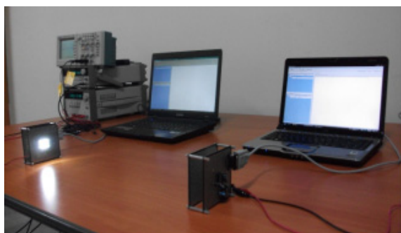
그림 7. 구현된 가시광 통신 프로토타입의 회로 검증, 파형 관측, 성능분석을 위한 실험 광경. Fig. 7. Experimental view for the circuit verification, waveform observation, performance analysis of the implemented visible light communication proto.
