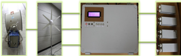
그림 14 풍력발전기 제동 실험 Fig. 14 Experiments of wind generator braking
