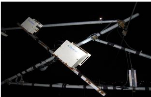
그림 1 경부2단계 고속철도 전차선로 전류검측을 위한 시스템 설치 사진
