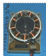
그림 1 BLDC 모터의 구조도
