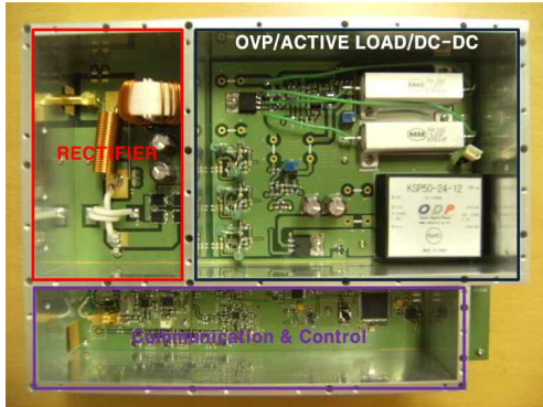
Fig. 6. The manufactured 1.7MHz receiver 그림 6. 제작된 1.7MHz대역 수신기 형상
