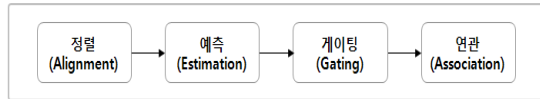
그림 4 센서필드에서의 불확실성 처리 절차 Fig. 4. Procedure for Uncertainty processing in sensor field
