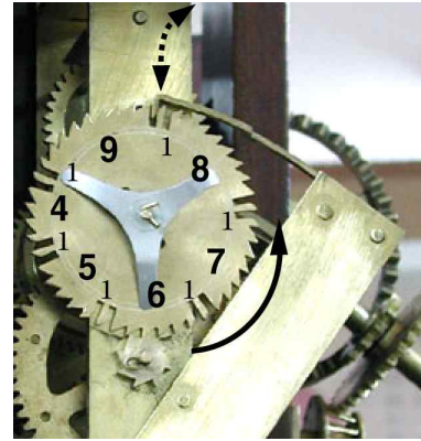
그림 5. 타종장치의 타종수기어 복원 사진. 타종수기어에 갈고리 모양의 타종제동장치(외부)가 물려 있다. 타종수기어에는 타종의 개수를 나타내는 숫자를 적어놓았다.
