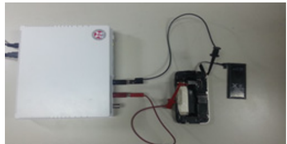
그림 6. iPhone4의 소비 에너지 측정을 위한 monsoon power monitor Fig. 6. The monsoon power monitor for measuring the consumed energy of iPhone4
