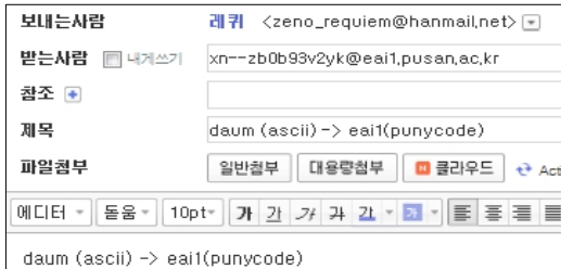
[그림 8] 1-3 다음(ASCII) → EAI1(다국어 유니코드) : 메일 보내기
