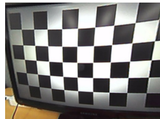
그림 7. 왜곡중심 오차 시 결과 화면 (X축: -30pixel, Y축: +30pixel)
