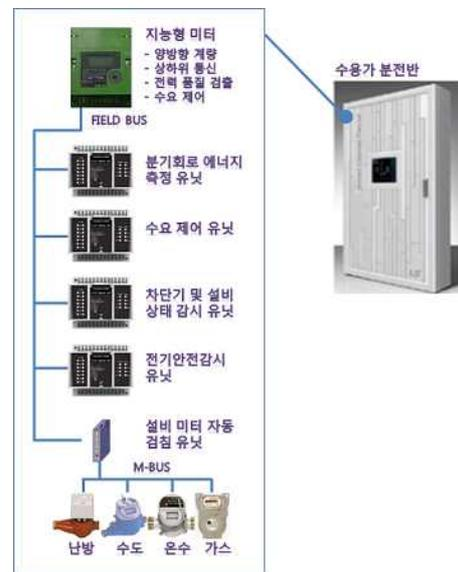
그림 1. 분기회로 전력관리 지능형 계측 제어 시스템
