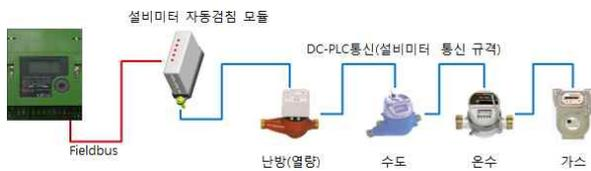
그림 6. 지능형 미터와 설비미터 자동검침 시스템 구성
