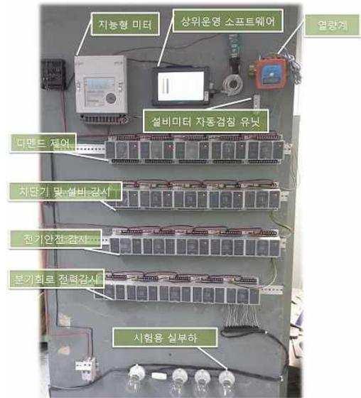
그림 7. 지능형 계측 제어 시스템 시제품
