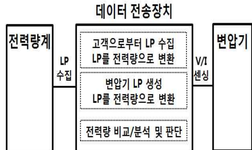
그림 4. 데이터 전송장치의 전력량 산정방법 Fig. 4. A calculation method of electric energy in DCU
