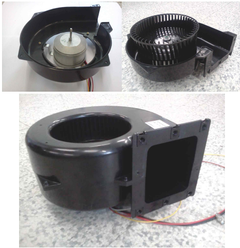
그림 9. 조립된 환풍기 Fig. 9. Assembled ventilation fan
