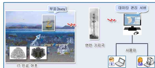
그림 5. IT 인공어초 관리 시스템 설계 Fig. 5 Design of IT artificial fish-reef system
