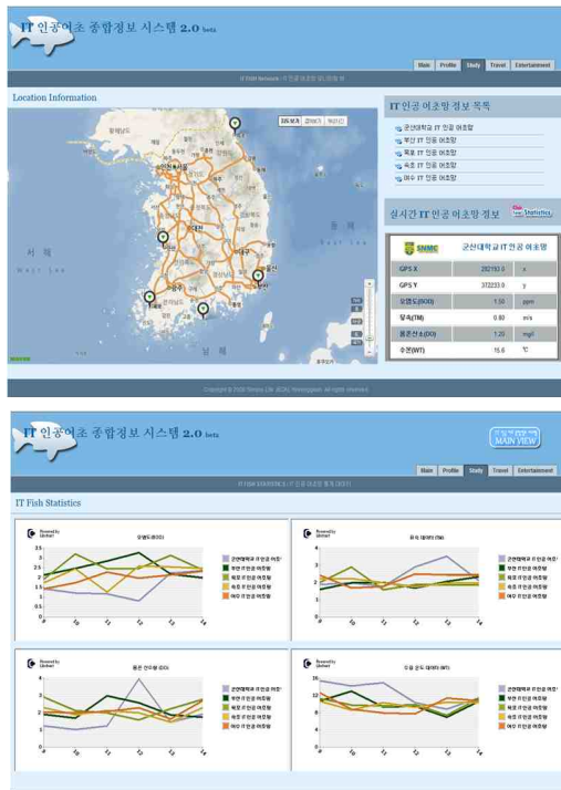
그림 9. IT 인공어초 관리 시스템 웹 페이지 화면 Fig. 1 Web screen of IT artificial fish-reef management system
