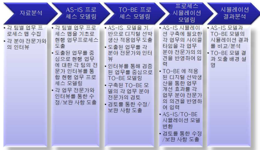
그림 1. 업무 프로세스 분석을 위한 BPR 프로시저 Fig. 1 BPR procedure for workflow analysis
