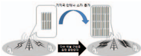
〈그림 5〉 Massive MIMO 개념도
