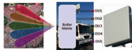
〈그림 6〉 Multi-Beam 안테나 개념도
