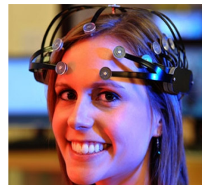
그림 2. 전식 전극을 탑재한 뇌파 측정용 헤드셋 착용 모습 Fig. 2. Headset with dry-type electrode
