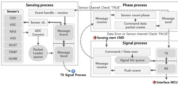
그림 5. 환경정보 센서 노드 블록다이어그램
