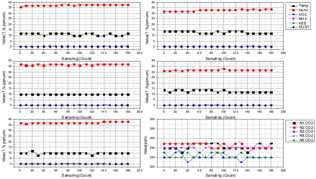
그림 13. 야간 노드 위치에 따른 데이터 변화량(좌측 상단부터 : Node1, Node2, Node3, Node4, Node5, CO2)
