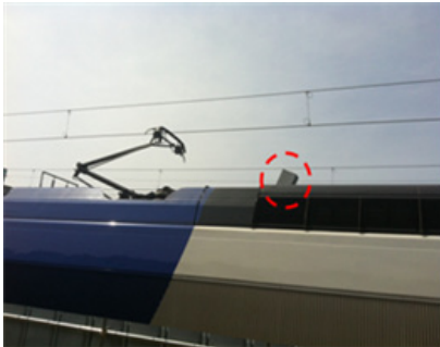
그림 5. 센서 및 비디오 장치 (Housing) 정면 및 측면 탑재 사진.
