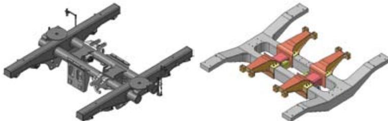
그림 2. 표준전동차 대차프레임과 복합소재 대차프레임
