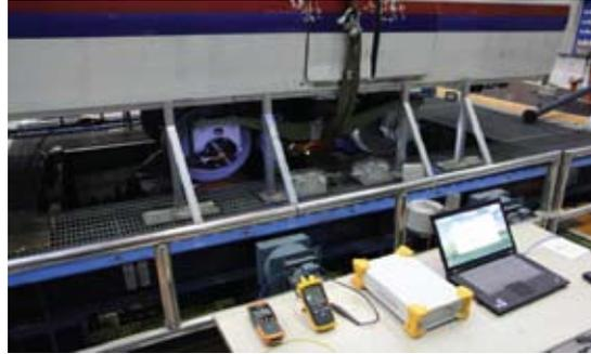
그림 9. 차축 건전성 모니터링 시험
