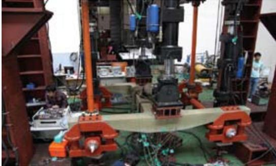
그림 5. 복합소재 대차프레임 건전성 모니터링 시험
