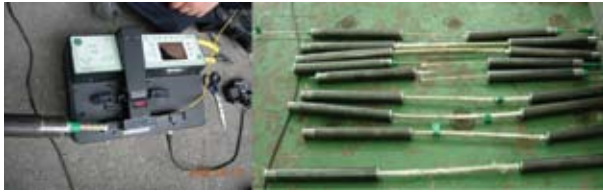
그림 1. FBG센서가 내장된 FRP Rebar
