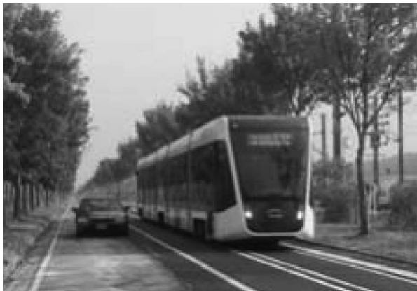
그림 1. 국내 개발 무가선티램 주행시험
