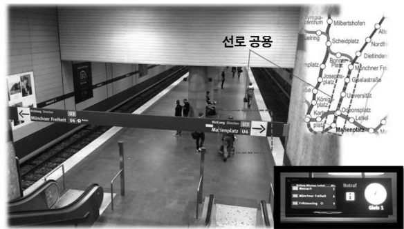
사진-3. U3와 U6가 일정 구간에서 선로와 승강장을 공유하여 동일 홈에서 환승하는 체계
