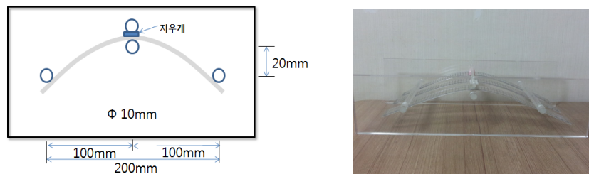
(a) ESC 실험장치(bent strip 방법) (b) 지우개, 시험편의 위치
