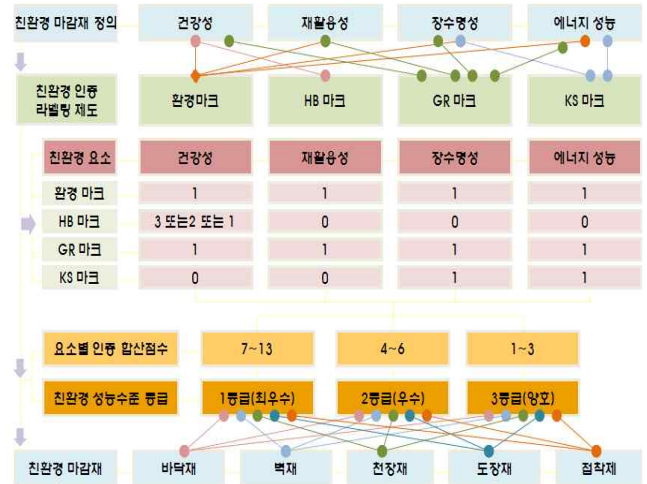
그림 2. 친환경 인증제도의 평가기준을 이용한 친환경 성능 판정기법
