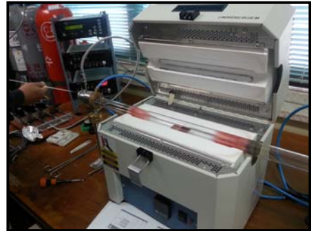
그림 1. CVD 시스템 Fig. 1 CVD system
