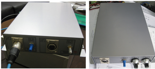
그림 9. 충돌방지 센서 ; (a) 송신기, (b) 수신기 Fig. 9 Collision avoidance Sensor ; (a) Transmitter, (b) Receiver
