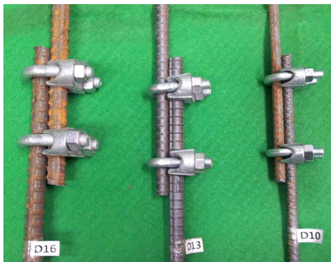
그림 9. 쥘쇠 접속한 철근 Fig. 9. Test samples of clamp joints rebar
