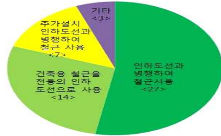
그림 1. 인하도선의 자연적 구성부재 사용실태 Fig. 1. Usage status of natural components for down-conductor
