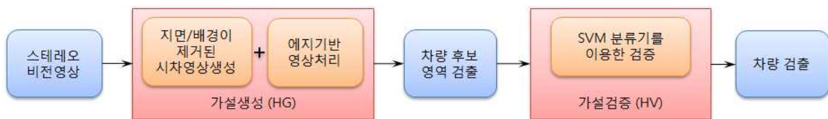
그림 2. 제안된 시스템의 차량 검출 과정
