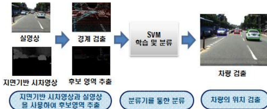
그림 9. 지면기반 영상을 이용한 차량 검출 과정
