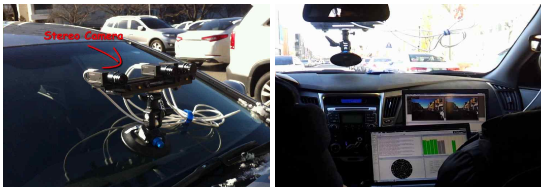
그림 14. 스테레오 시스템을 이용한 실험 환경
