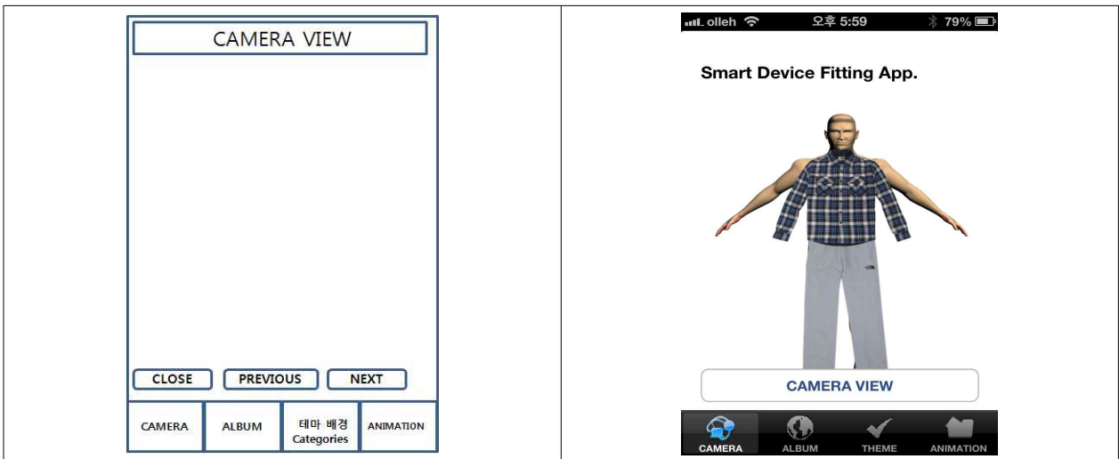
그림 9. 아이폰 기반의 패션 피팅 시스템 카메라 뷰 화면 UI설계
