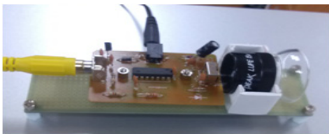
그림 6. 수신부 시스템 구성도 Fig. 6. Receiver.
