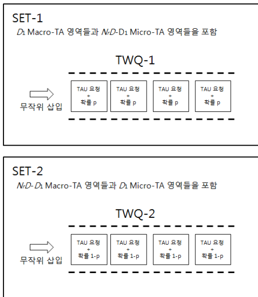
그림 4. IMMT 구조 개념도 Fig. 4. IMMT architecture conceptual diagram.
