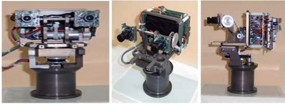
그림 1. 스테레오 비전 시스템 사진 Fig. 1 A picture of the stereo vision system
