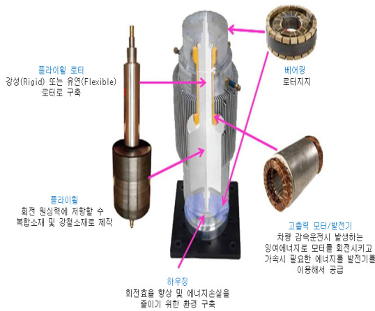
그림 2 플라이휠 에너지 저장 장치 구성 Fig. 2 Configuration of the flywheel energy storage system
