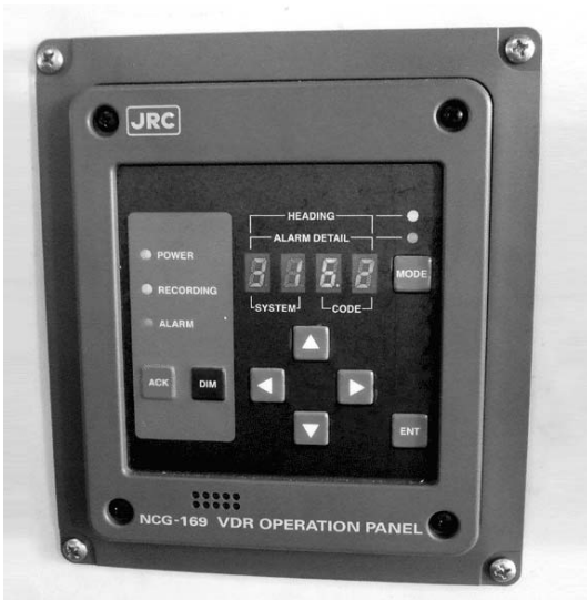
(그림 8) JRC사 항해자료기록장치 원격제어패널 샘플 사진
