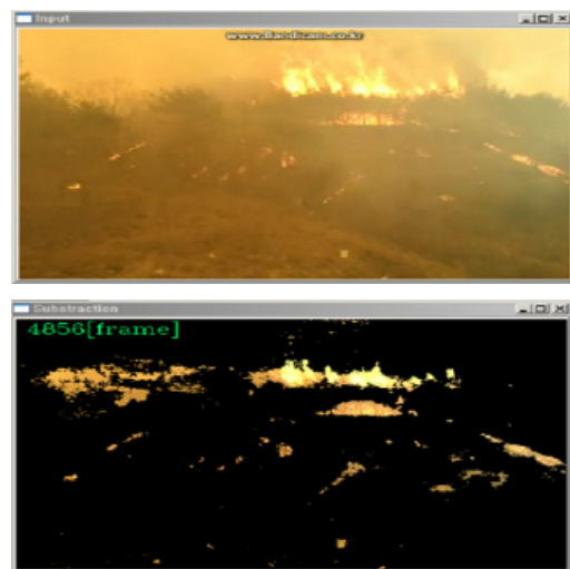
그림 7. 산불 화재 감지 시스템의 산불 검출 결과
