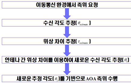
그림 4. 알고리즘 흐름도 Fig. 4 Algorithm flow chart
