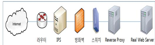
(그림 2) Reverse Proxy를 이용한 DDoS방어
