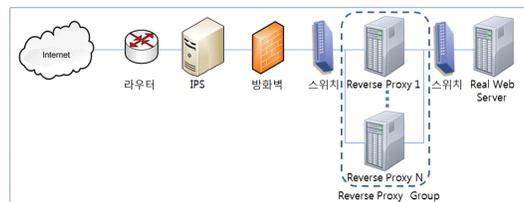
(그림 3) Reverse Proxy Group를 이용한 DDoS방어
