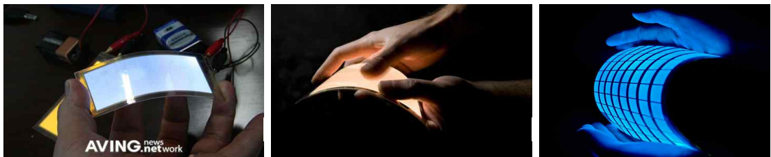
그림 13. Flexible OLED 조명 기술개발 : AVING, AGFA Materials, Estman Kodak
