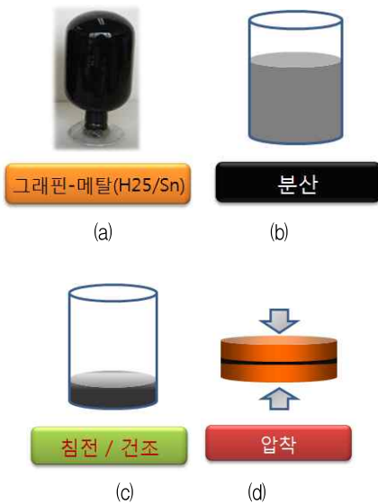
그림 11. 그래핀-메탈 융합체를 이용한 heat-spreader 제조 공정(분산/압착법)
