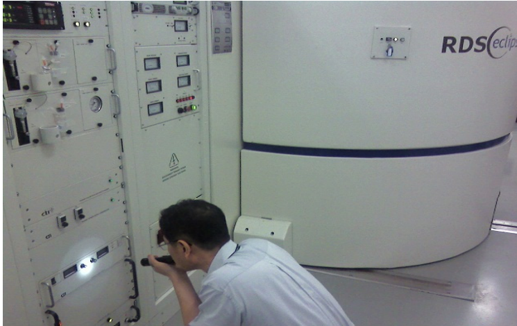
〈그림 5〉 PET Net Korea의 박형철 엔지니어가 EM에 들어간 사이클로트론을 점검하고 있다. 우측의 큰 원통부분이 입자를 가속시키는 D전극이 들어있는 사이클로트론 본체다. 이SY 팀장의 허락 하에 박형철 엔지니어를 따라 이곳에 들어가 참여관찰을 행할 수 있었다. 사진에 찍힌 공간은 〈그림 4〉에서 활짝 열린 우측 문으로 통하는 공간이다. 1년여의 참여관찰 동안 연구자는 이 문이 열린 것을 단 두 번 볼 수 있었는데, 그 중 한번이 지금 서술하고 있는 EM 때였다. 이처럼 기술과학적 실행은 예기치 못하던 물질계의 저항을 접하게 되며, 그 때에는 평소에 블랙박스화되어 하나의 결절(結節, punctualization)된 단일 행위자-연결망으로 작동하던 개체들이 뚜껑을 열고 해리(解離)된 모습을 보이게 된다
