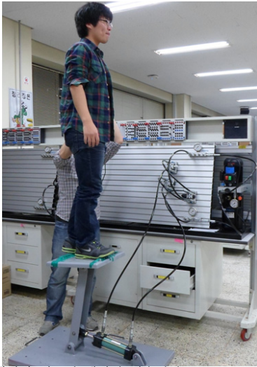
그림 11. 개발된 카운터 밸런싱 실습장치 Fig. 11. Developed counter balancing experimental equipment
