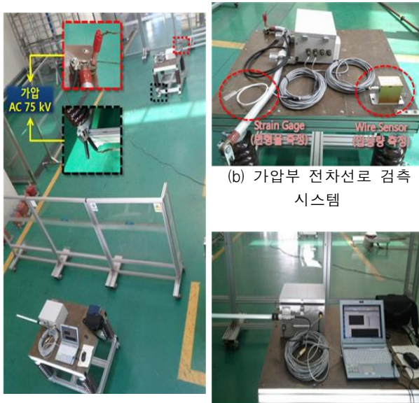
(a) AC 75 kV 가압시험 진행 (b) 가압부 전차선로 검측 시스템 (c) 지상부 모니터링 장치 그림 5 전차선 압상량 검측장치의 상용주파 내전압 시험 사진 Fig. 5 Picture of power frequency withstand voltage testing for uplift measurement system of contact wire
