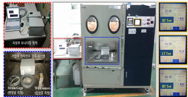
(b) 항습조 챔버를 이용한 온도시험 진행
