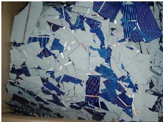
Fig. 11. 기존 스크린 프린팅 전도성 패턴 형성 시 스쿠지 압력에 의해 파손된 결정질 실리콘 웨이퍼.
