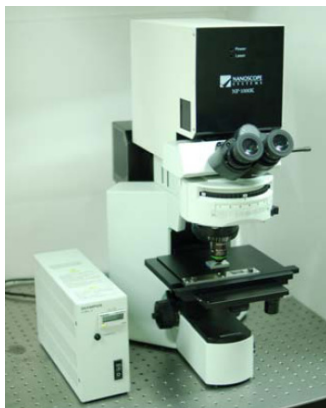
그림 2. 제작된 형광 관측 장치 Fig. 2 Our optical fluorescence measurement device
