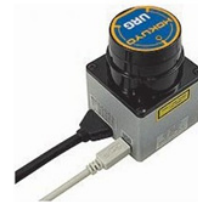
그림 4. 레이저파인더의 구조 Fig. 4 Structure of Laserfinder
