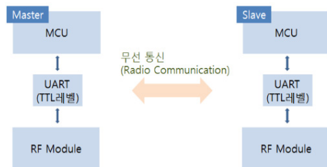
그림 11. RF통신 인터페이스 동작 확인 및 송수신 흐름도
